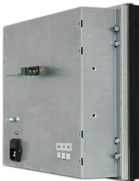
Unser TFT-Industrie-Monitor ersetzt mit einem modernen Konzept ausgediente oder defekte 12"Röhrenmonitore in BÜHLER Maschinensteuerungen.
