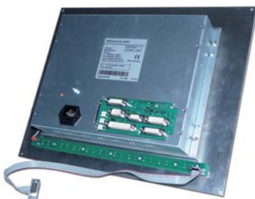
Adapterkabel Tastaturanschluss (Pfostenverbinder 10-pol. → 9pol. D-Sub (2reihig))
