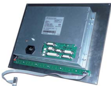
Adapterkabel Tastaturanschluss (Pfostenverbinder 10-pol. → 9pol. D-Sub (2reihig))
