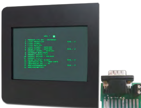
2361912 / 12V DC (über Monitorstecker) - Frontplatte 315 x 344 mm - Anschluss: Monitorstecker 10pol.
