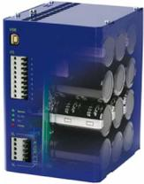
Bei Ausfall der Netzspannung ermöglicht das Puffermodul ein gesichertes Abschalten ohne Datenverlust. Bei einer Unterbrechung der Spannungsversorgung wird die Energie der Ultrakondensatoren geregelt freigesetzt. Die Last wird vom Puffermodul gespeist, bis dieses entladen ist. Die Pufferzeit ist vom Ladezustand des Kondensators und vom Entladestrom abhängig.
